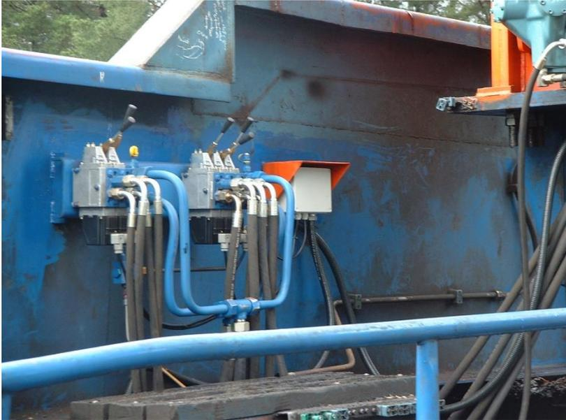
Accionamiento manual por palanca hidráulica a distancia.
